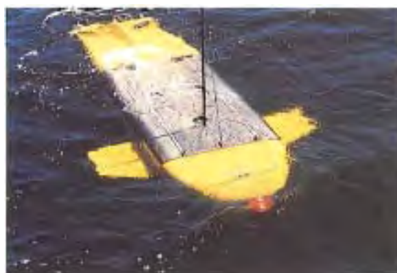
Figuras 56 e 57 — Mini-submarino autónomo para recolha de dados oceanográficos e imagens submarinos. Projecto EUREKA — EU1249 Stirling AUV.
