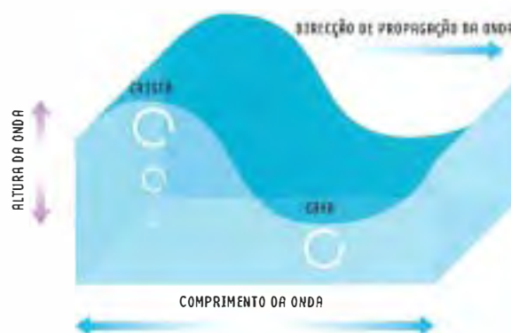
Figura 10.4 – Esquema ilustrativo de algumas das características das ondas de superfície: altura e comprimento do ondo, direcção de propagação de onda, trajectórias descritas pelas partículas de água à passagem da onda.
